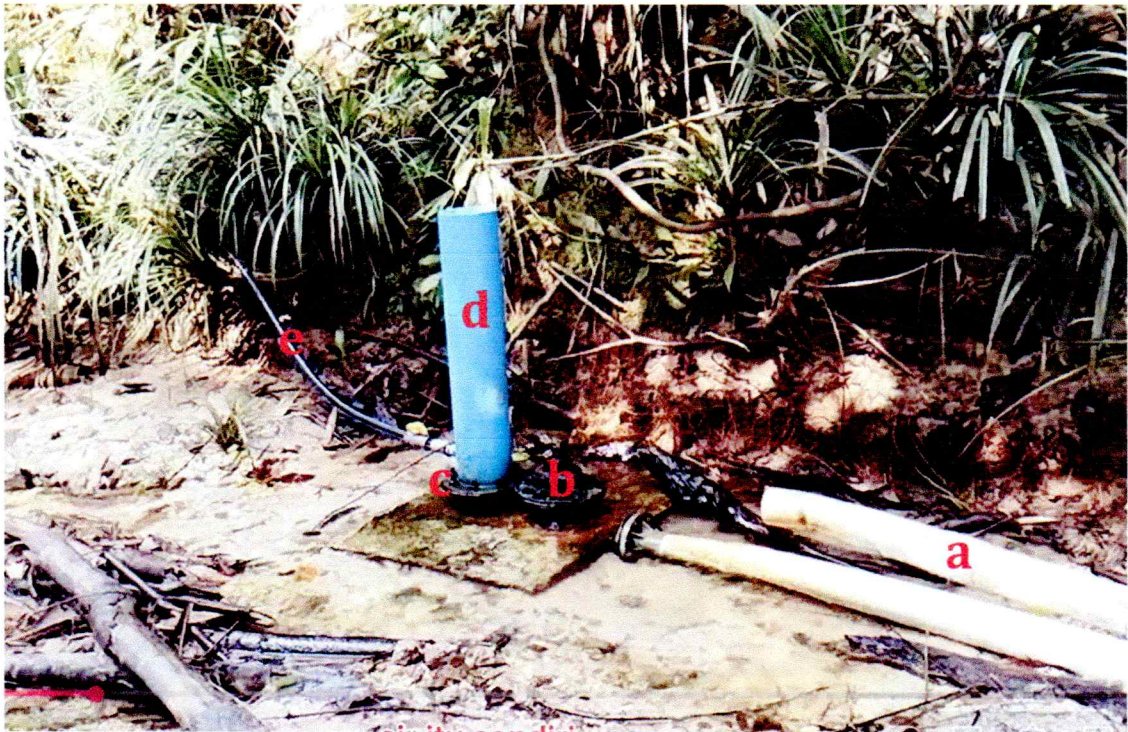
Pipa pemasukan (a), katub limbah (b), katub penghantar (c), tabung udara (d), pipa distrbusi (e)
